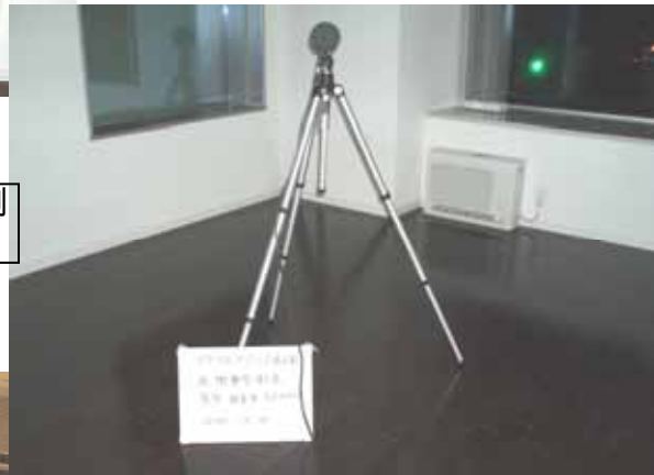
音源側 軽量音発生器 タッピングマシン
