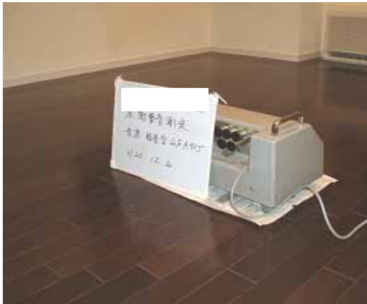
音源側 重量音発生器 バグマシン
