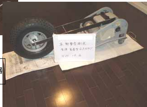
音源側 軽量音発生器 タッピングマシン
